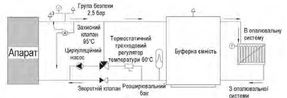
Рис. 5. Рекомендована схема приєднання апарата до закритої системи опалення
