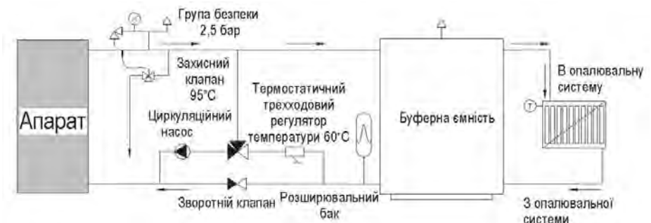
Рис. 6. Рекомендована схема приєднання апарата до закритої системи опалення
